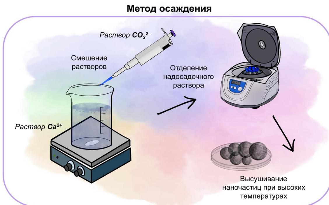
Рисунок 2.3 – Схема синтеза СаНЧ методом осаждения
