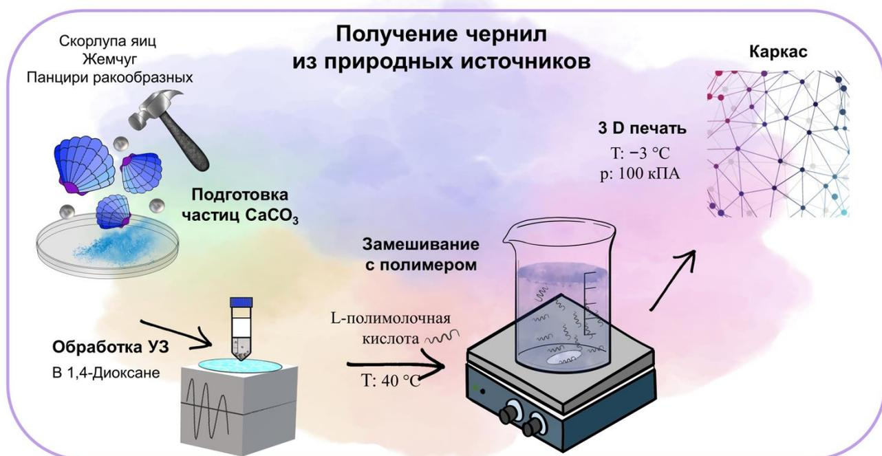
Рисунок 2.20 – Схема получения чернил на основе карбоната кальция [215]
