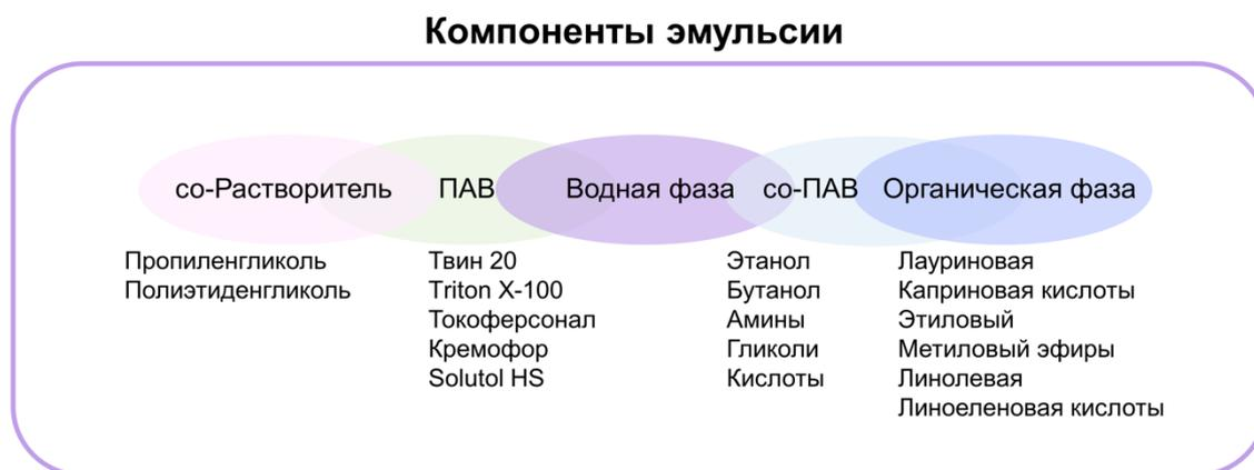
Рисунок 2.6 – Схема компонентов реакционной смеси для метода эмульсии
