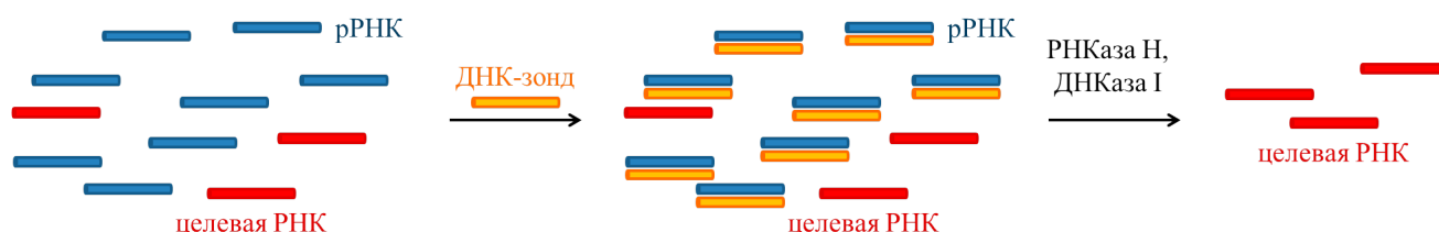
Рисунок 1.21 — Схема выделения целевой РНК с помощью ферментативного расщепления рРНК.
