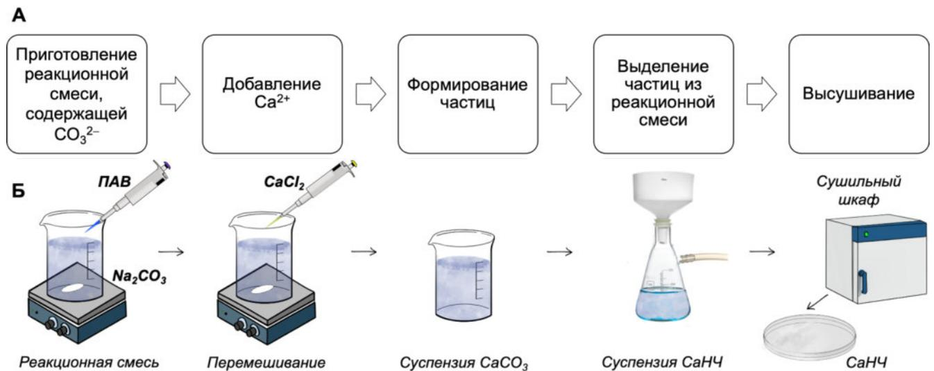
Рисунок 2.2 – Схема синтеза СаНЧ методом осаждения (А) и его частный пример (Б) [42]
