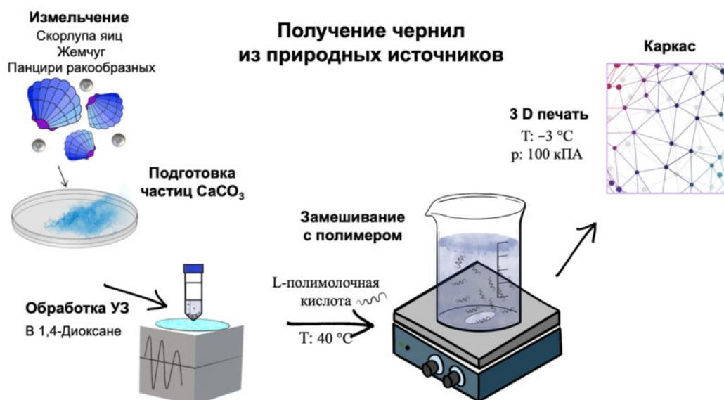
Рисунок 2.18 – Схема получения чернил на основе карбоната кальция [239]
