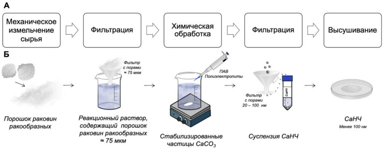
Рисунок 2.6 – Схема синтеза CaNC биогенным методом (А) и его частный пример (Б) [102]
